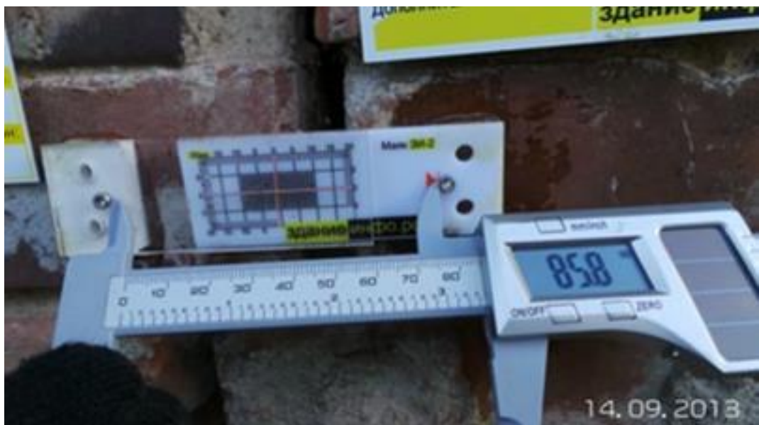
Пример 5. Замер штангенциркулем Маяка пластинчатого типа
