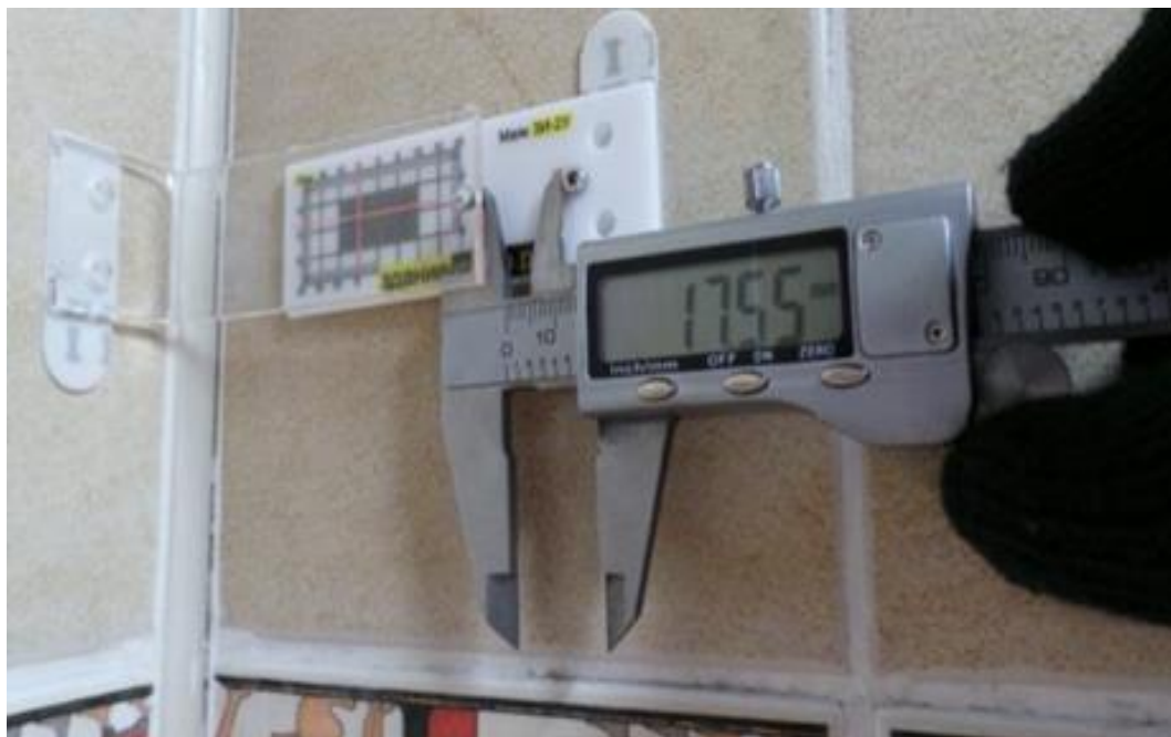
Пример 3. Замер штангенциркулем после установки маяка углового пластинчатого типа.
